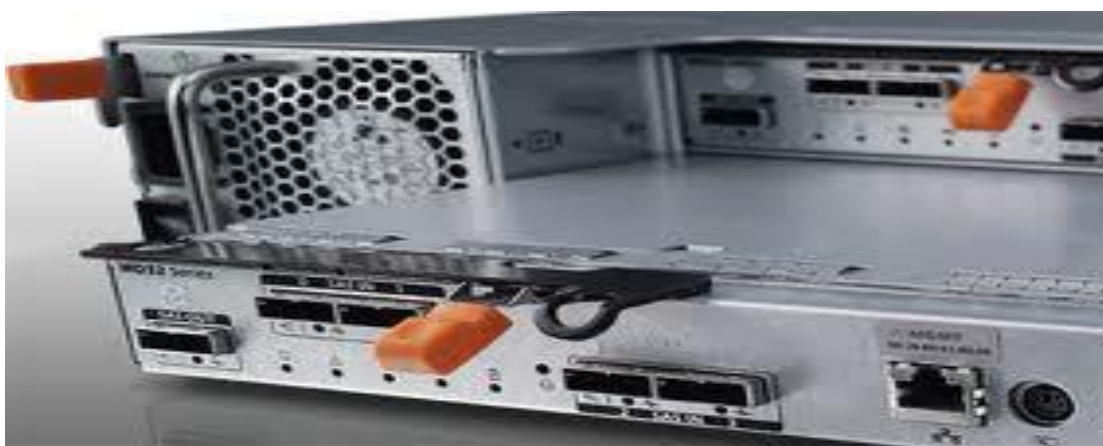
Figura 38: Exemplo de Storage SAS com duas placas de comunicação usadas em DAS .
