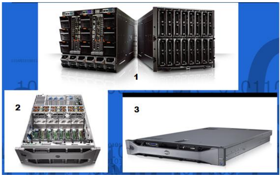
Figura 42: Equipamentos com grande capacidade de memória e processamento usados em virtualização.
